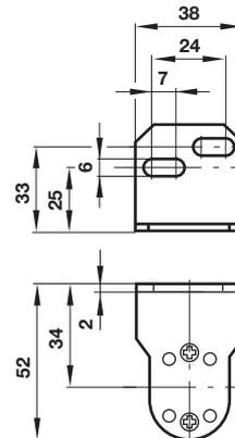
Sie benötigen 1/8" (3 mm) Schrauben, um den Befestigungswinkel an der Wand zu montieren.
