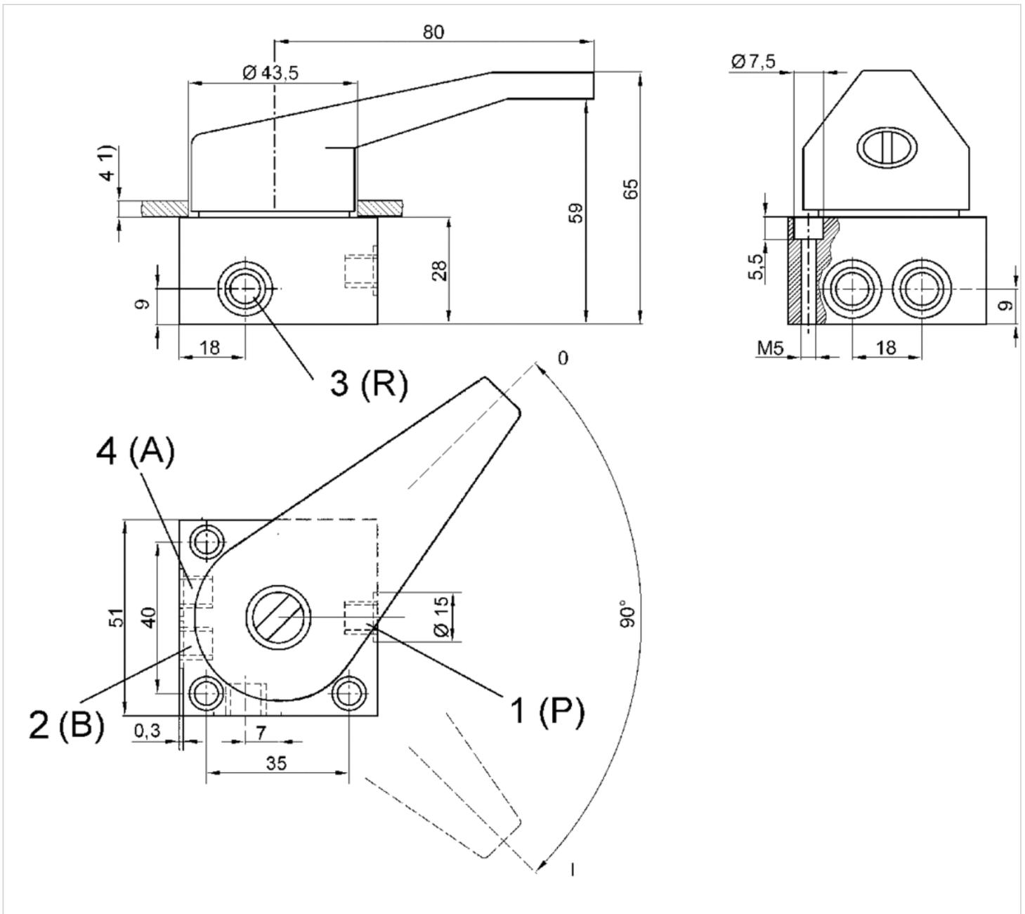
1) Max.Pos. 0: Anschluss 1 ▶ Anschluss 4; Anschluss 2 ▶ Anschluss 3
